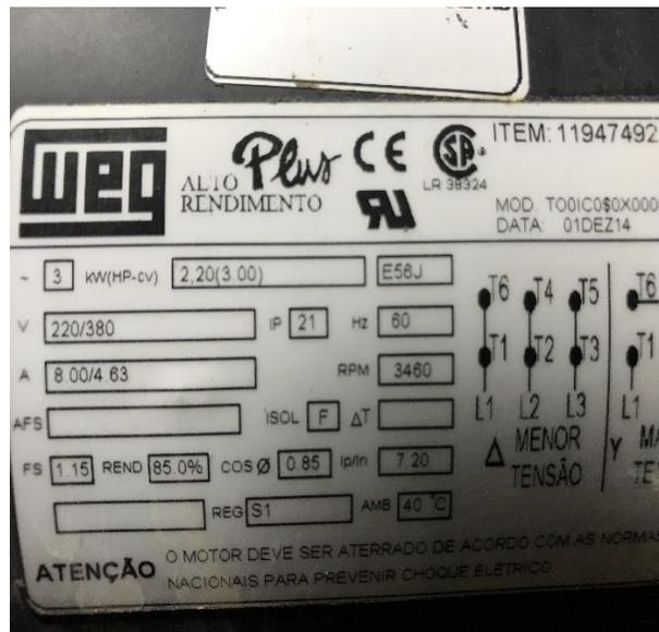
Fig. 96 – Placa do motor da bomba
