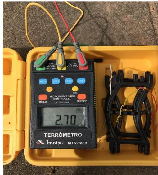
Fig. 106 – Medição de resist. ôhmica(1)      Fig. 107 – Medição de resist. ôhmica(2)
