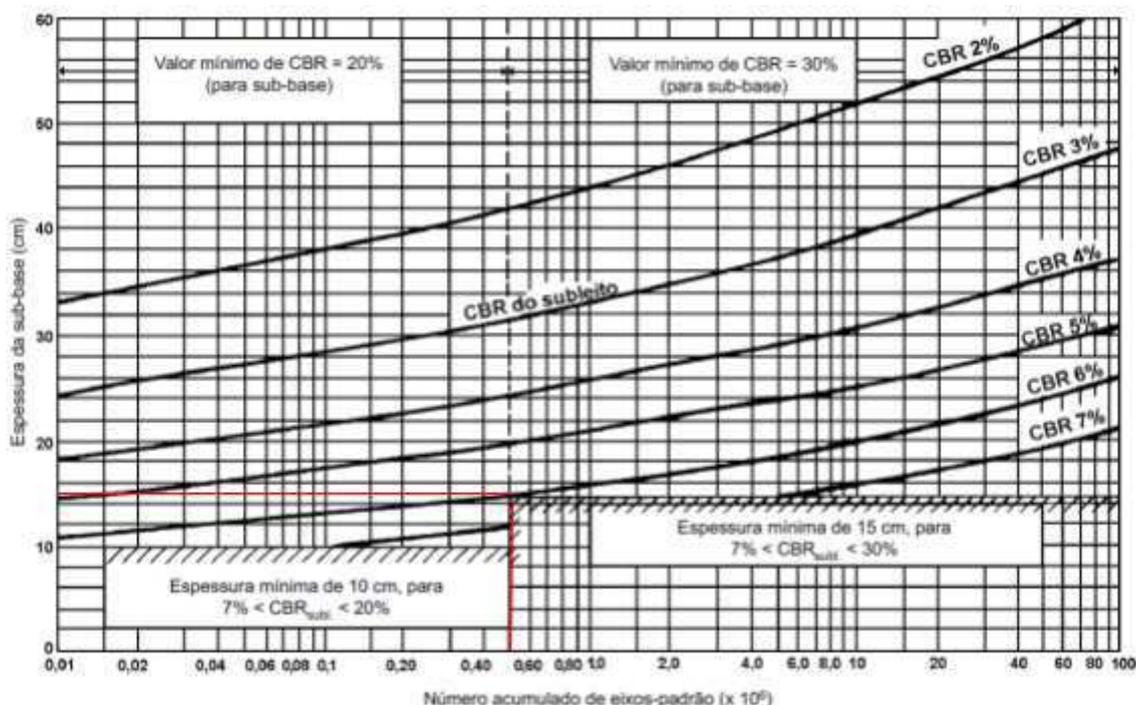
Ábaco 01: Espessura necessária para sub-base. Fonte: ABCP (1998).
