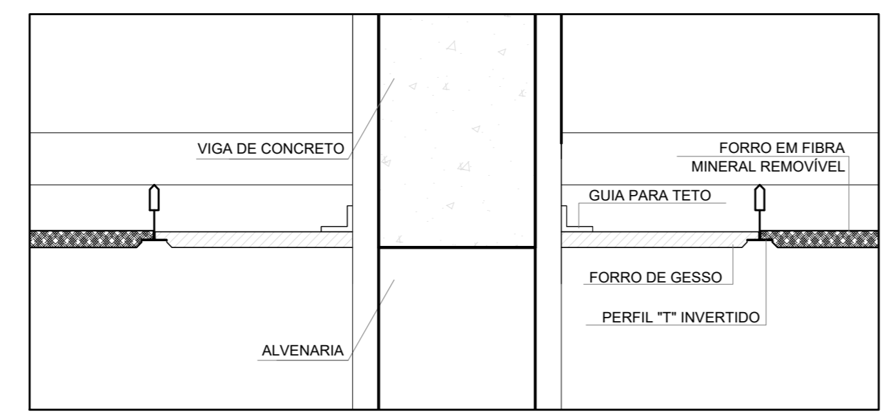
3 DETALHE 2: FORRO MINERAL E GESSO ESCALA 1/5
